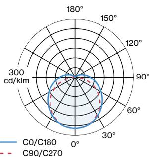
[2561T8B5] Bei den technischen Daten handelt es sich um Bemessungswerte für eine Umgebungstemperatur von 25°C. Die Angaben zum Lichtstrom unterliegen initial einer Toleranz von +/- 10%, jene zur elektrischen Anschlussleistung initial einer Toleranz von +/- 10%, und jene zur Farbtemperatur initial +/- 150 Kelvin. Es wird keine Haftung für Druckfehler übernommen. Es gelten die AGB der Wever & Ducré BVBA.
